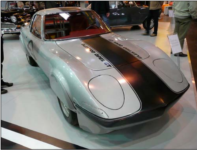
Elekro OPEL GT oli 1971 rakennettu sähköauto jossa oli 160 hevosvoimaa ja toimintasäde 44 kilometriä. Ikkunoista näkyi akkuelineet jotka täyttivät koko matkustamon, vain kuljettaja mahtui kyytiin.
