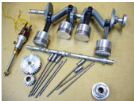
Moottorin osat: kampiakseli, männät, nokka-akseli, venttiilien nostotangot, virranjakaja ja ratat.
